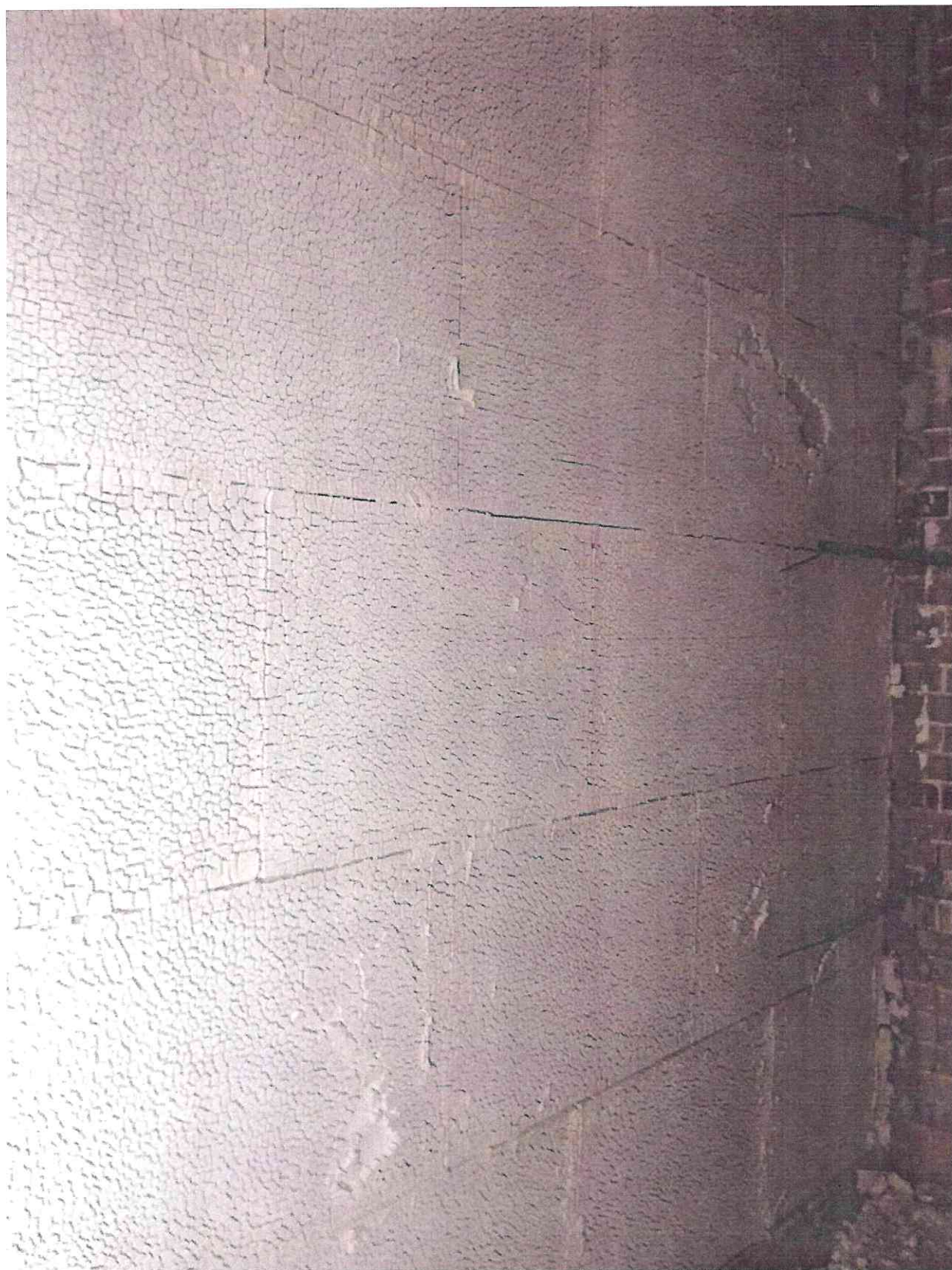
Рисунок 8 – Вид образцов со стороны огневого воздействия после испытаний.
