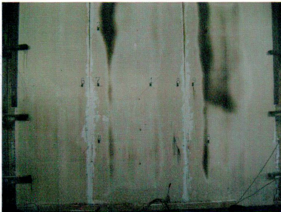
Фото №2. Перегородка каркасно-обшивная по металлическому каркасу толщиной 148мм после проведения испытания.
