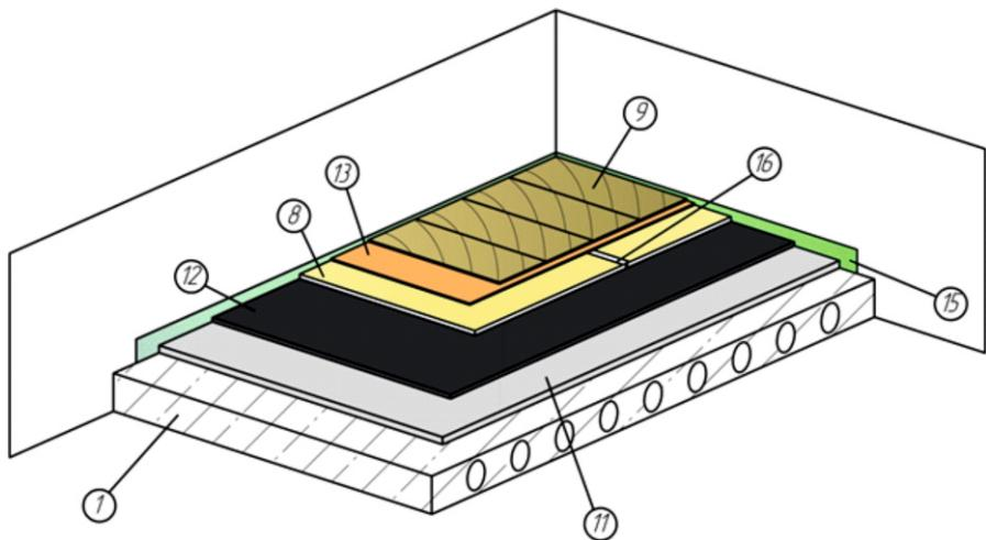
**6.0.4. Сборные стяжки полов по выровненной сухой засыпке на железобетонном основании**
