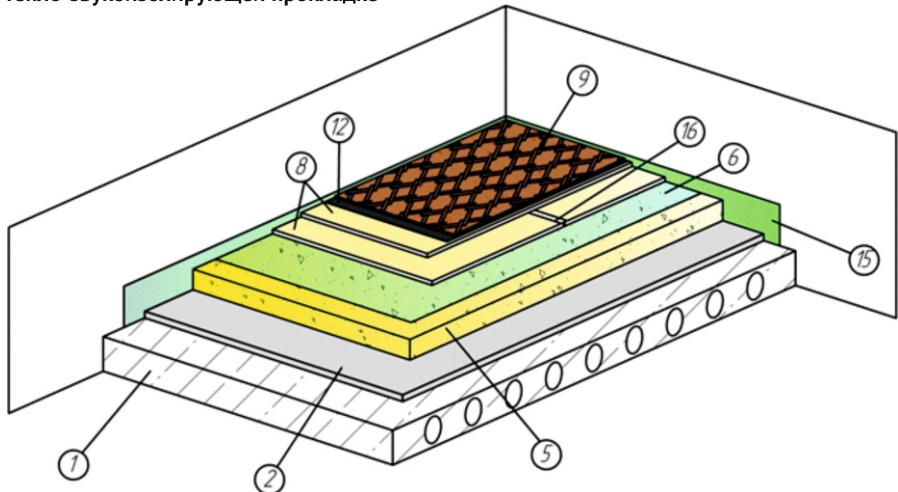
**6.0.3. Сборные стяжки полов по самонивелирующейся стяжке на железобетонном основании (в случае замены фанеры)**
